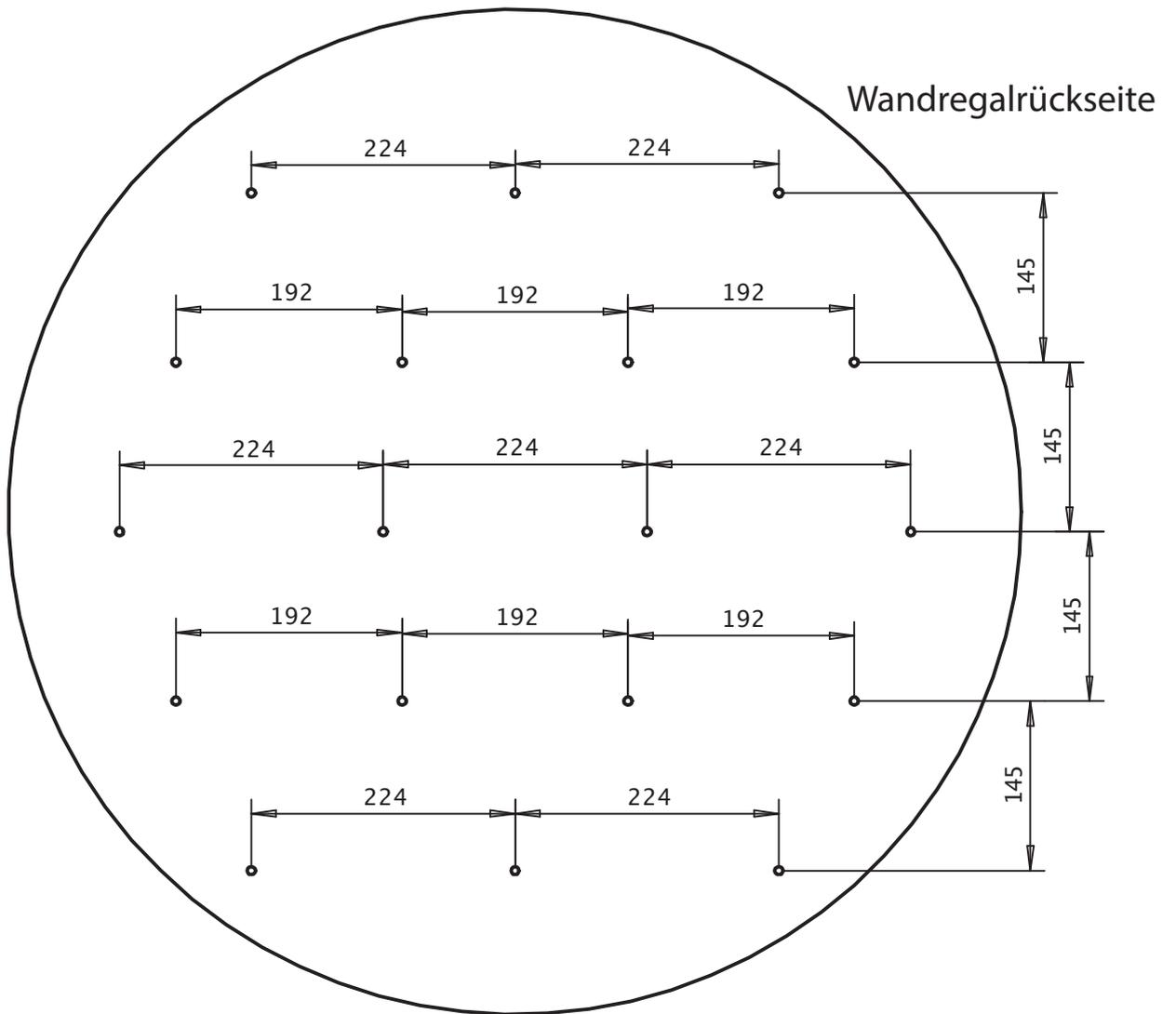
Alle 5 Böden werden an die Regalwand mit der Nut nach oben zeigend von der Rückseite des Kreiselements aus mit den Verbindungsschrauben verschraubt.
